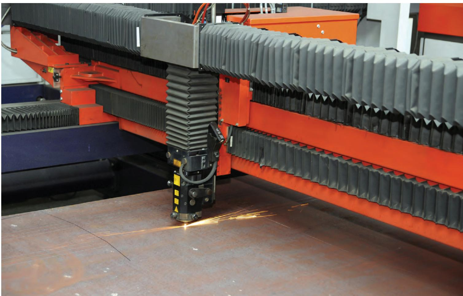
Les composants des machines de découpe laser de haute technologie sont protégés par des soufflets fabriqués avec des matériaux produits par Dickson PTL.
